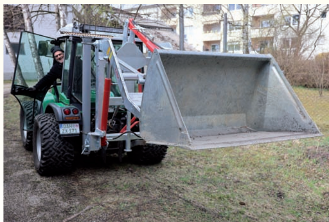
Mit solch einer am Hecklader montierten Schaufel können Heinz Gibowsky (hier im Traktor) und die anderen Freiwilligen der Bund Naturschutz-Kreisgruppe Dachau beispielsweise Erde auf Lastwagen heben oder Kies planieren. Foto: rds
